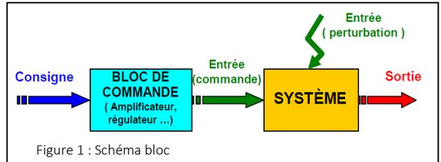
Figure 1 : Schéma bloc
