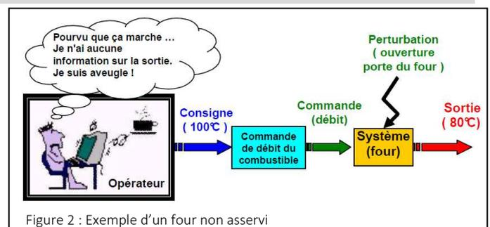
Figure 2 : Exemple d'un four non asservi
